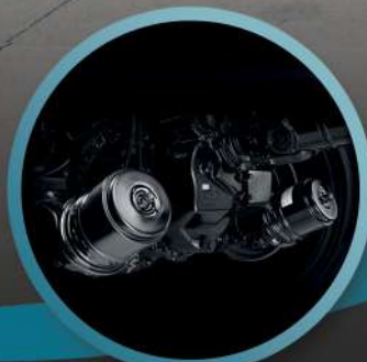
● ระบบเบรคแบบลมลื่น พร้อมปรับตั้งเบรคอัตโนมัติ
